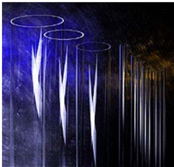
Der Werkstoff kann in zahlreichen verschiedenen Ausführungen und Spezifikationen hergestellt werden. Der Bereich Glas wird nochmals unterteilt in die Bereiche Kalk-Natron-Glas für Leuchtstofflampen, Quarzglas für die Lichtindustrie, Kalium-Natrium-Barium-Glas für Kompaktleuchtstofflampen und Zwischenglas zur vakuumdichten Verbindung von Wolfram und Quarzglas.
